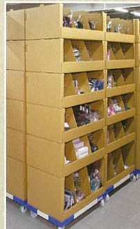
軽量な上、アングルキャリアに乗せて使用するので一人でも楽に移動可能
